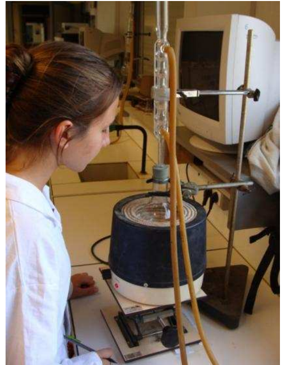
Chauffage à reflux d'une décoction de choux rouge
