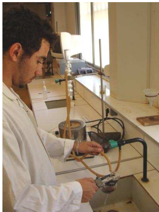
Refroidissement du milieu réactionnel avant titrage
