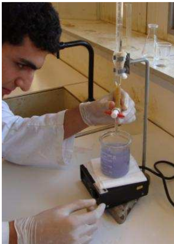
Titration « à la goutte » de l'éthanol extrait
