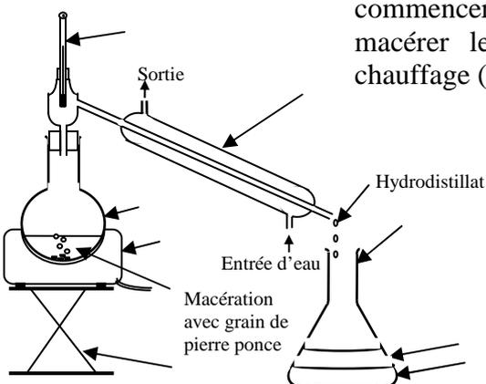
E.15. : Mettre en marche la circulation d'eau dans le réfrigérant et commencer à chauffer modérément (thermostat à mi parcours) pour faire macérer le mélange pendant environ 10 min. Augmenter ensuite le chauffage (thermostat « à fond ») pour distiller.
